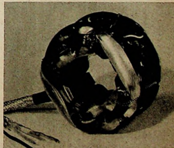
Abb. 17. Ablenkensystem mit genutzten Ringkernen im Saba-Fernsehempfänger „Schauslands T 44“
